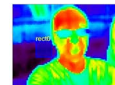
図2 サーモカメラを用いた体温計測例
